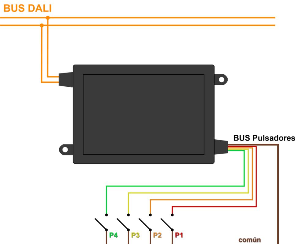
Figura 1: Conexión del equipo al Bus DALI, y de los pulsadores al equipo
